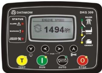
DKG-309 - это комплексный агрегат AMF для автономной работы с резервным генератором или с двойной генераторной установкой. Устройство доступно с версиями MPU или CANBUS. Версия CANBUS подключается к электронным двигателям с электронным управлением ECU, обеспечивающим управление двигателем, защиту и контрольно-измерительные приборы без дополнительных отправителей. Сигналы ECU отображаются в тексте.
